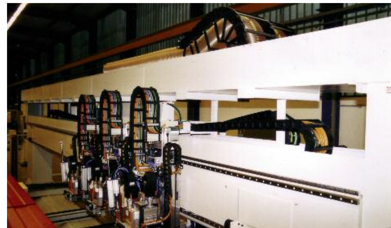
Holzbearbeitungsmaschinen mit e-ketten® und chainflex®-Leitungen
