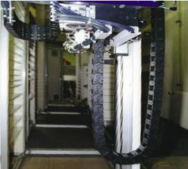
Metallfreie Lichtenwellenleiter für schnelle Handlinganwendungen. e-kette®: System E2/000
