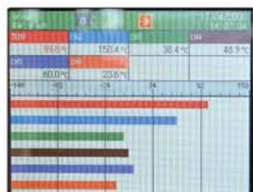
Balkenanzeige der Mess- und berechneten Kanäle (gleichzeitig mit Echtzeittrend darstellbar)
