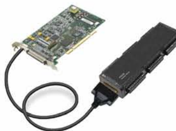
OMB-DAQBOARD-3000 mit Erweiterungsmodul OMB-PDQ30 (zusätzliche 48 einseitig geerdete / 24 differenzielle Analogeingänge oder 24 Thermoelementeingänge)
