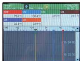
Kombinierte Trendanzeige Anzeige von Echtzeittrend und Trendhistorie Die Trendhistorie kann auf der Zeitachse verschoben werden.
