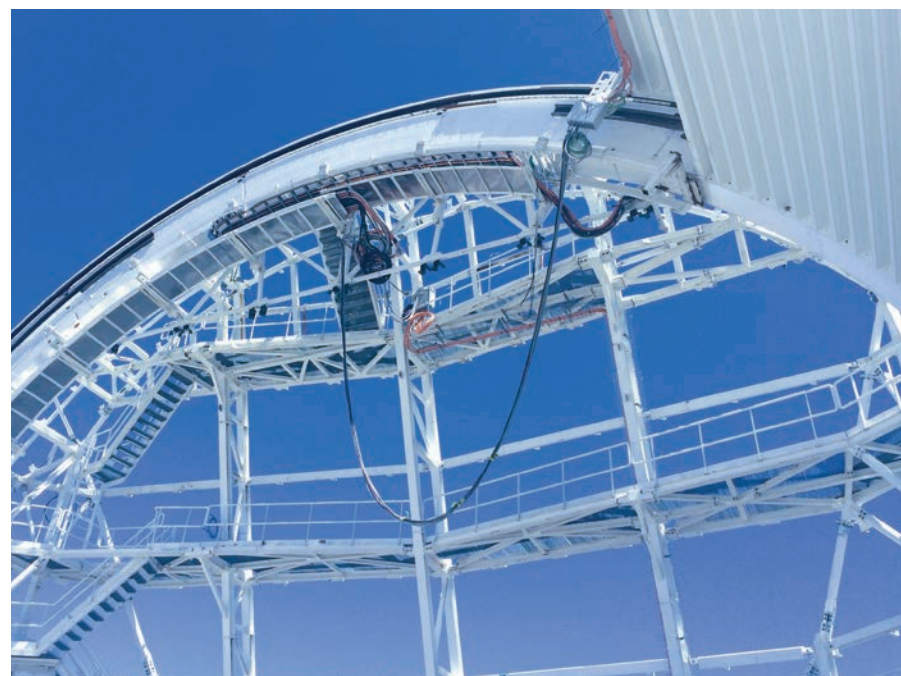
Das spanische Unternehmen IDOM setzte beim Bau der bewegten Kuppel des DKIST Solar-Teleskops auf Energieführungsketten von TSUBAKI KABELSCHLEPP
