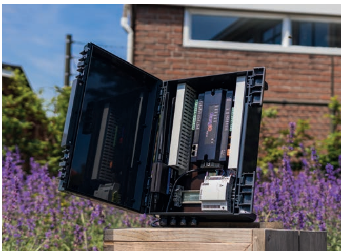
Die empfindliche Elektronik des Hero Balancer ist in einem Gehäuse der Bocube-Serie von BOPLA untergebracht Bild: Hero Balancer
