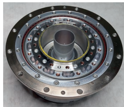
Eine strukturell integrierter Drehmomentsensor in den Gelenken liefert Drehmomentwerte frei von Reibungseinflüssen in den Lagern oder im Getriebe. Bild: DLR
