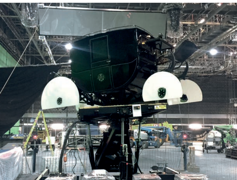
Die von sogenannten Thestralen gezogene Kutsche bei „Phantastische Tierwesen“ 2 verwendet SIKO-Seilzuggeber für Drehungen.
