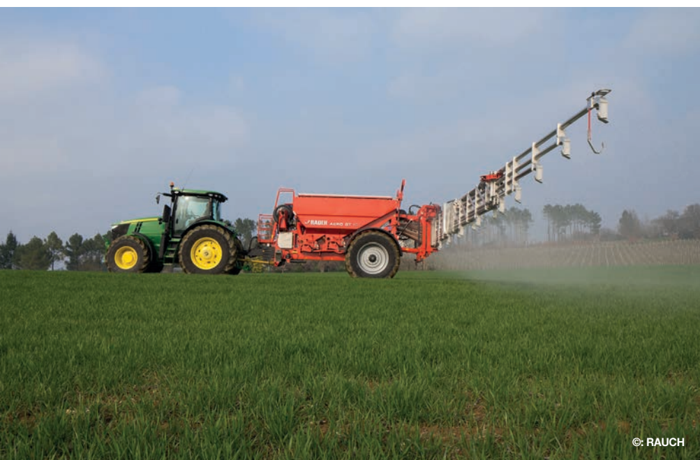
Exakt-Düngerstreuer der neuen Aero-Reihe: Punktgenau und kleinräumig Streuen statt Schleudern.
