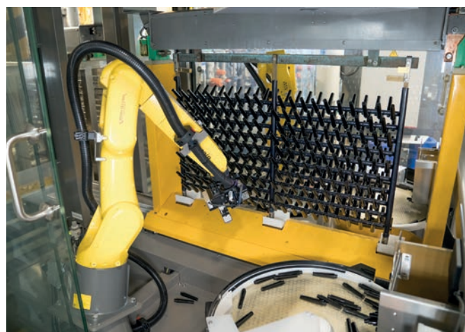
Der Roboterarm bestückt die Haken vollautomatisch, bevor das Gestell ins Galvanikbad getaucht wird. © Baumer
