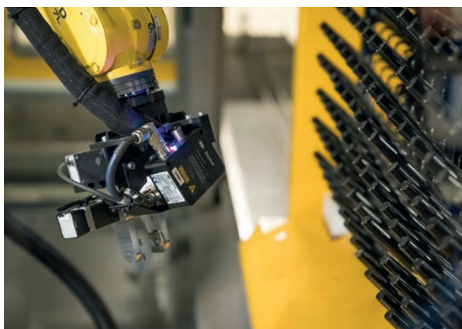
Der Profilsensor OXM200 am Greifer erfasst die individuellen Hakenposition und schickt die Koordinaten an die Steuerung. © Baumer
