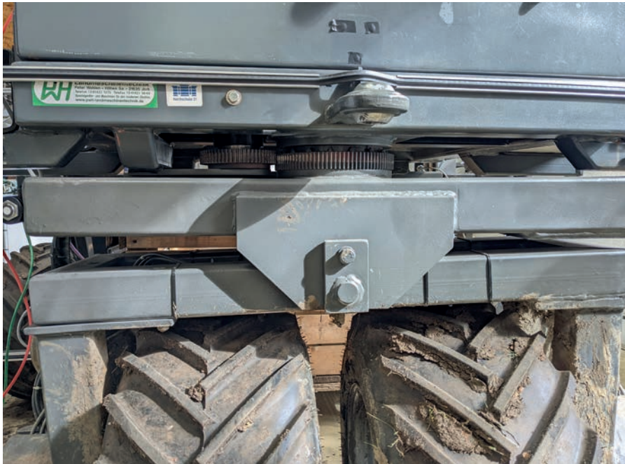
Der Multiturn-Drehgeber WV5800M erfasst den Lenkwinkel, damit das Fahrzeug seinen definierten Pfad sicher umsetzen kann.
