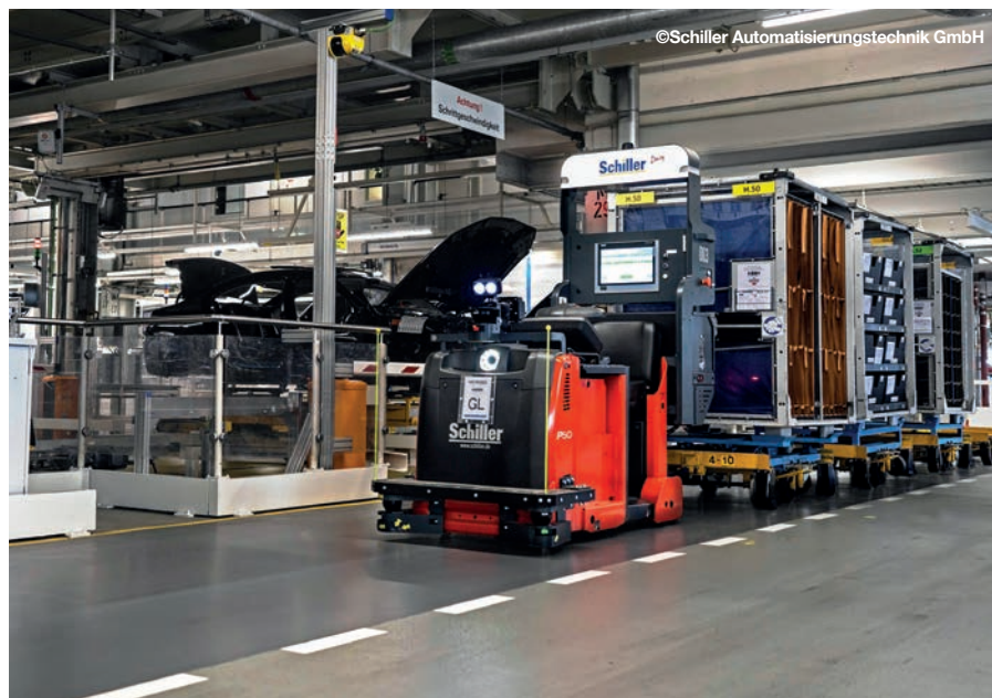
Autonomer Transport von 500 Tonnen Material vom Lager zur Montage täglich dank Digitalisierung und Autonomisierung der Logistikaufgaben mit einer fahrerlosen Routenzug-Flotte.
