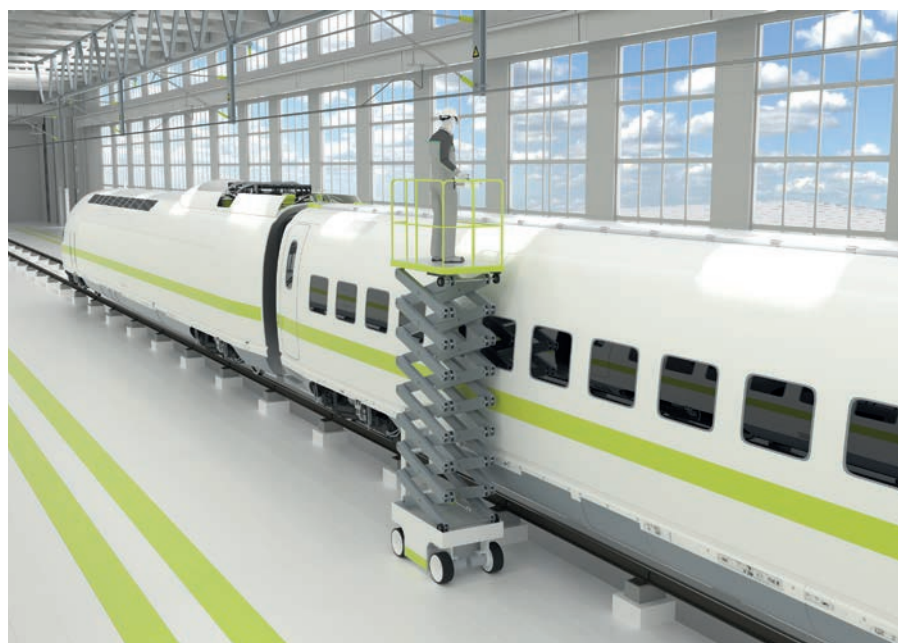
Mit Hilfe des RFID Systems wird die Position der Hubarbeitsbühne sicher bestimmt und die Hebebühne nur dann ausgefahren wenn das Segment stromfrei geschaltet ist.
