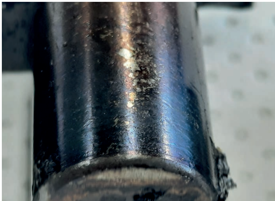
Hitzeverfärbungen an einer Zylinderrolle in Folge von Heißlauf
