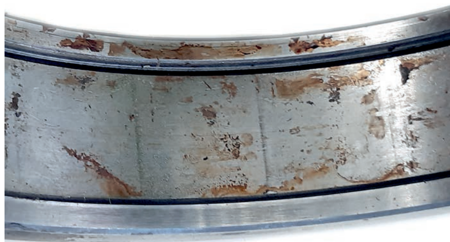
Beginnende Reibkorrosion an der Außenringlaufbahn eines Zylinderrollenlagers
