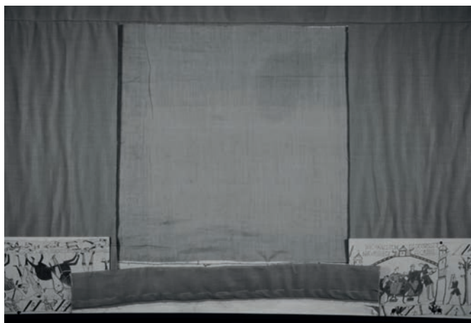
IDS-Kameraperspektive für die 2D-Dehnungsanalyse
