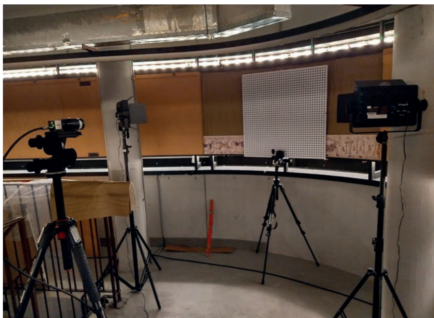
Eine Kalibrierplatte dient zur Berechnung der 2D-Position der Kamera in Bezug auf das Objekt und zur Korrektur jeglicher Art von Verzerrung durch Kamera und Objektiv.
